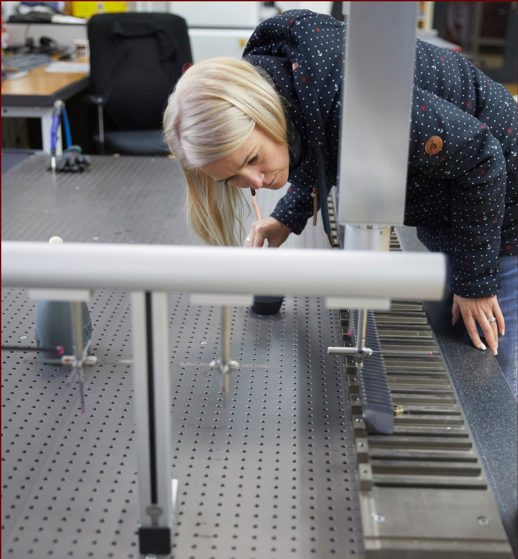
Die Werkhallen der Güdel Group in Langenthal: Masskontrolle einer im Werk 1 gefertigten Zahnstange auf einer Koordinatenmessmaschine.
